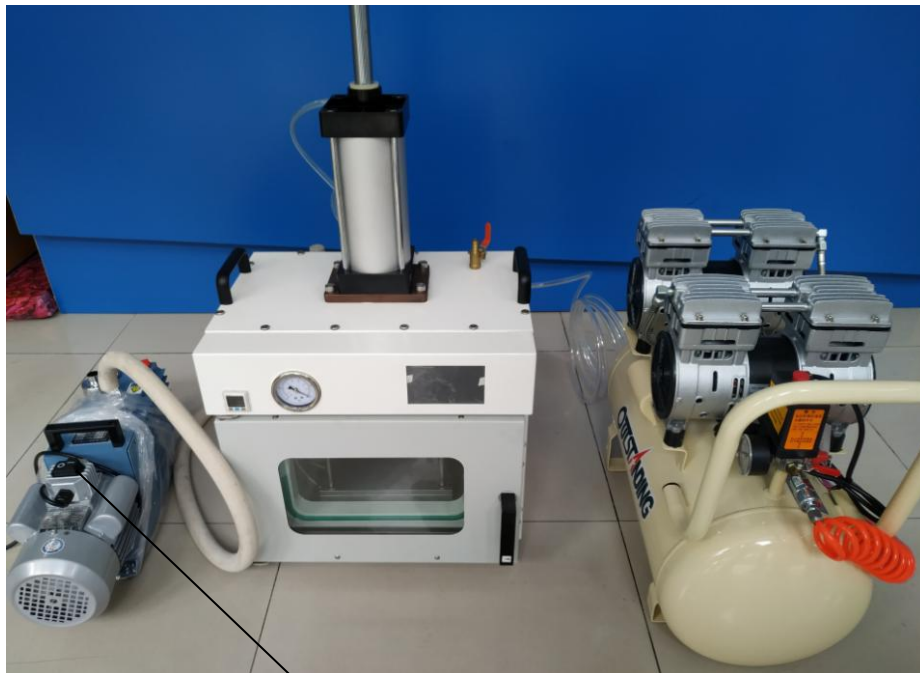
真空抽气管连接，真空泵打开
