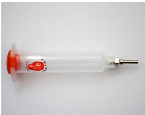
基于离心管和注射器针头改装而成，针头规格如下，产品价格较低，针头可更换。
