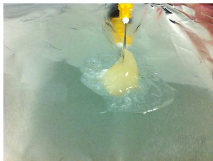
(3) 用注射器针头蘸取 AB 胶，整齐、均匀地涂抹于 PEEK 底座上；AB 胶涂抹要适量，胶太多会堵住芯片孔，胶太少两个接触面间会有缝隙，封合不紧密。
