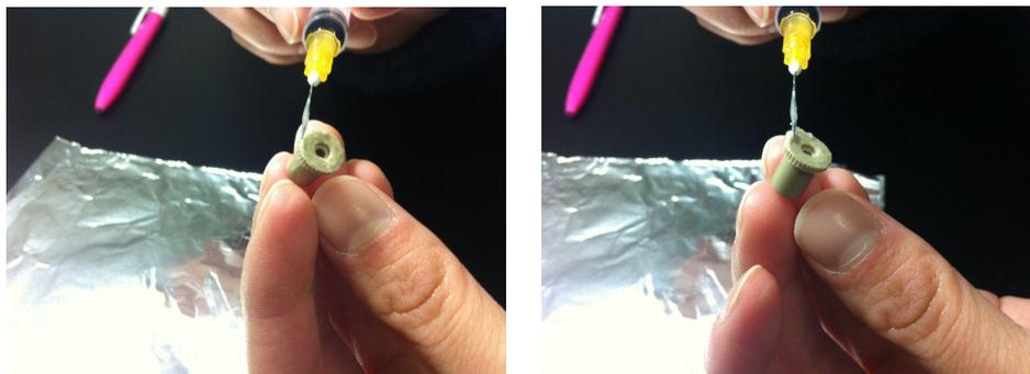
(4) 对准芯片上待粘结的孔，将涂抹上 AB 胶的 PEEK 底座放到需要粘的孔上，稍微用力旋转并按压一下 PEEK 底座，一方面可以使其固定于芯片上，另一方面可以避免存在于 PEEK 底座和芯片之间的间隙；但也不要太过用力按压接头，太过用力按压会导致 AB 胶堵住进样孔。
