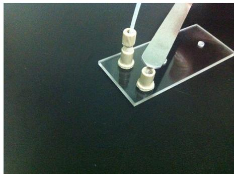
(5) 在水平桌面上静置一会，AB 胶完全固化后，适当修饰掉边缘多余的 AB 胶。
