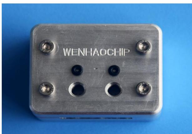
5) 将 peek 接头插入接口处拧紧，在 peek 接头中插入 PTFE 管，夹具组装完成。
