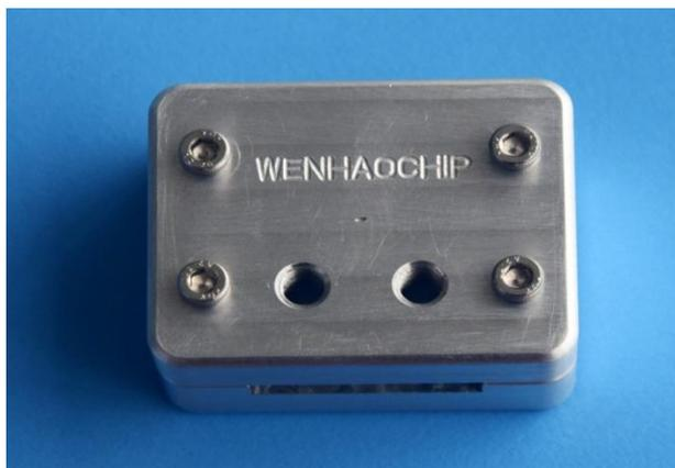
4) 将垫圈放入上下盖板接口处，垫圈对准芯片打孔处。
